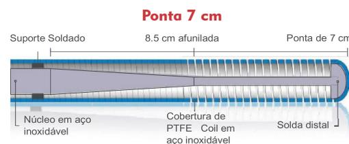
Para proteção da propriedade intelectual, esses diagramas são simbólicos, não possuem especificidade de engenharia. A construção da guia varia de acordo com o tamanho do produto. Diagramas sem escala.
